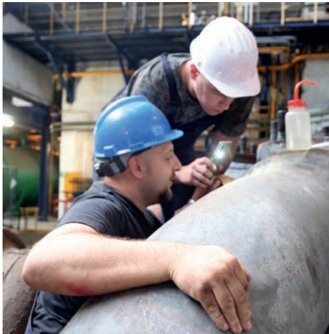
■ Провера о постојању напрслина на цевима ВП блока А2
