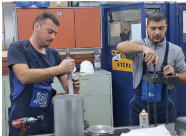
■ Мирослав и Драгослав Ступар – Поправка пнеуматског погона вентила из багер станице
