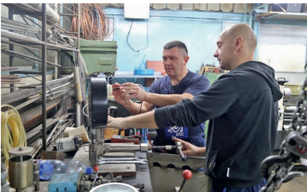
■ Саша Милетић и Стеван Николић - Подешавање граничне вредности пресостата помоћу баждарне пресе
