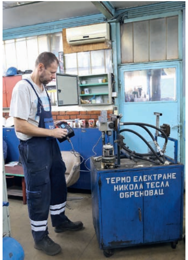
■ Младен Недељковић испитује хидраулични пропорционални разводник
