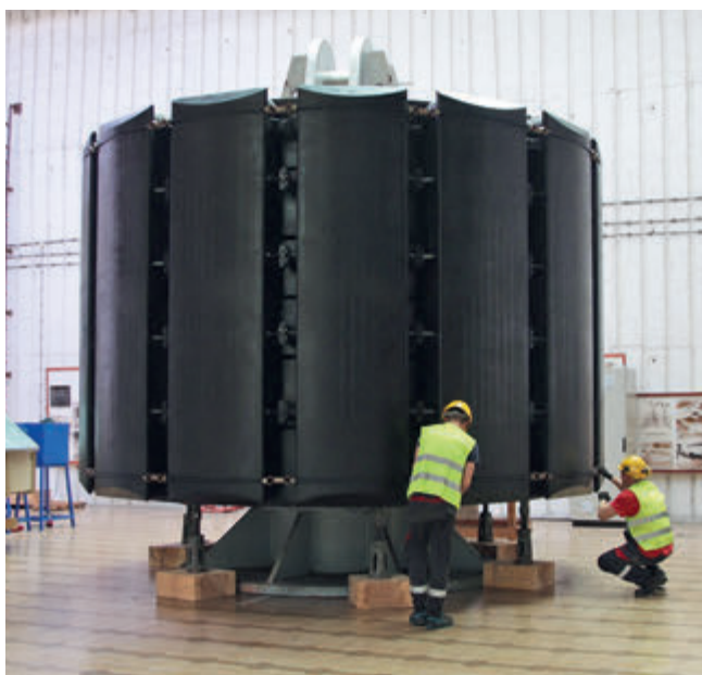
■ Ротор на монтажном простору
