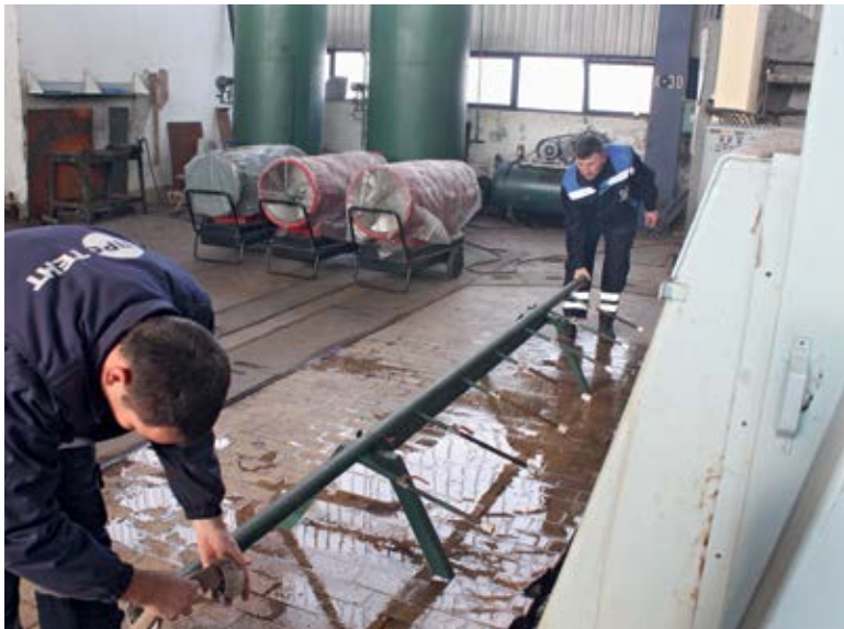
■ Цев са млазницама за одлеђивање и спирање
