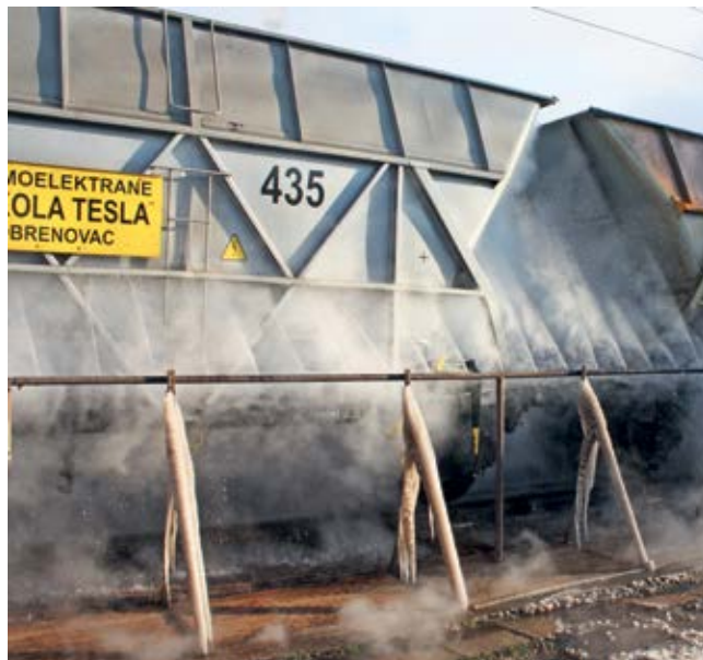
■ Постројење за одмрзавање радио пуном паром
