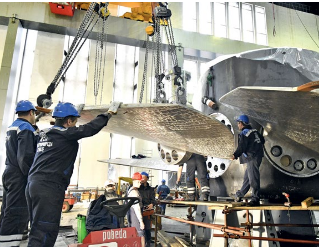
■ Лопатице радног кола су нове, с напреднијом геометријом
