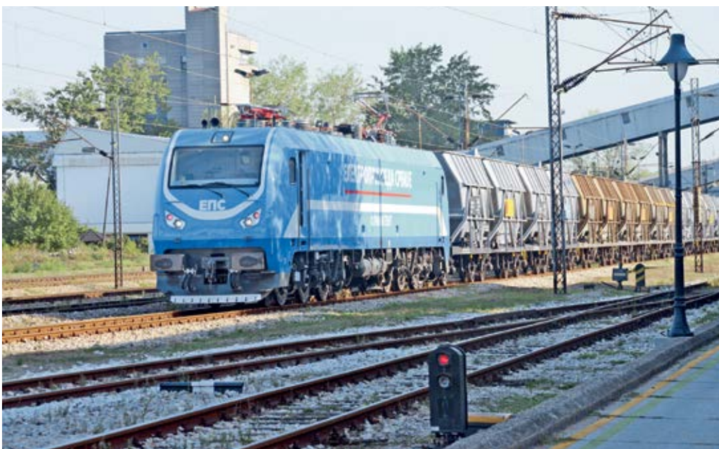
■ Електричним кочењем новог возила враћа се 20 одсто потрошене електричне енергије
