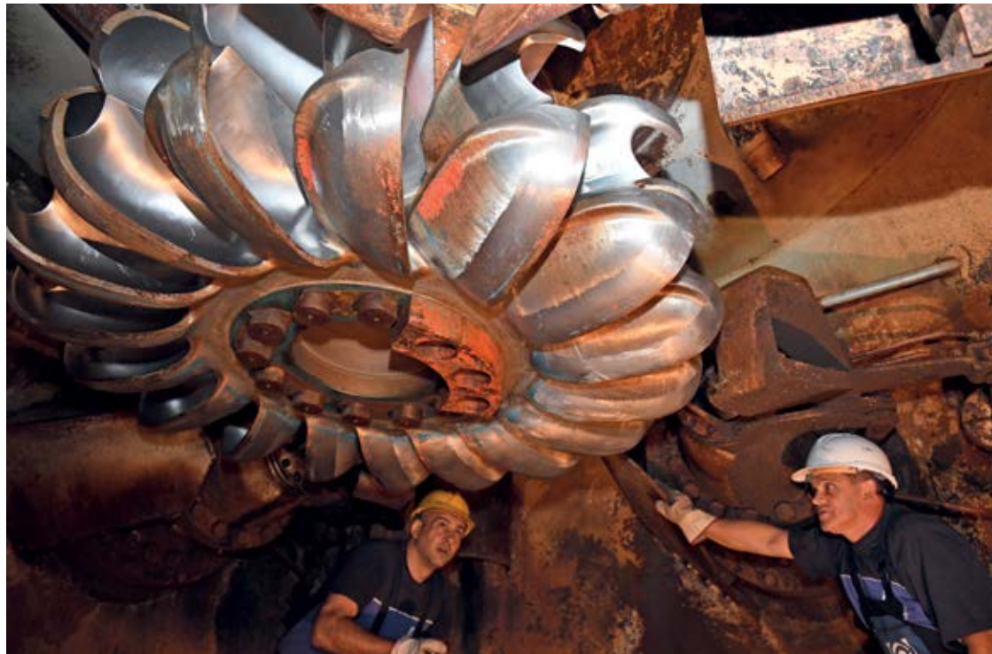
■ Кавитација метала је уобичајна појава на радном колу
