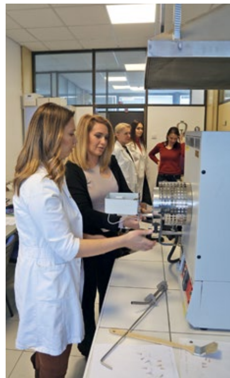
■ Одређивање топивости pepела на АФТ уређају
