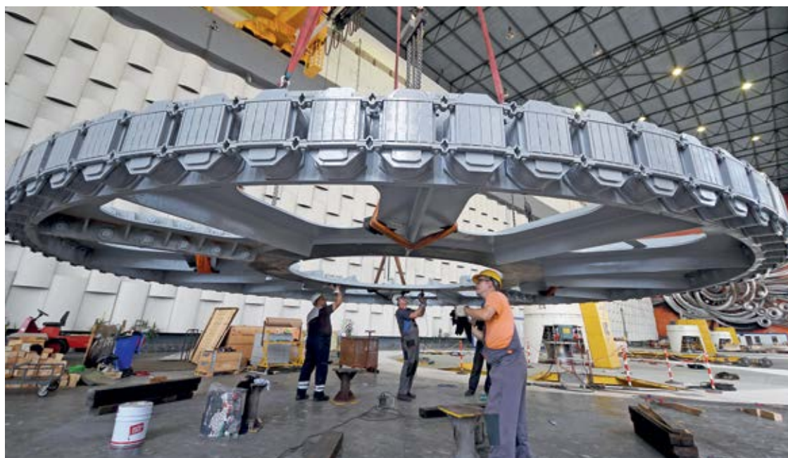
■ Припрема ротора помоћног генератора за транспорт
