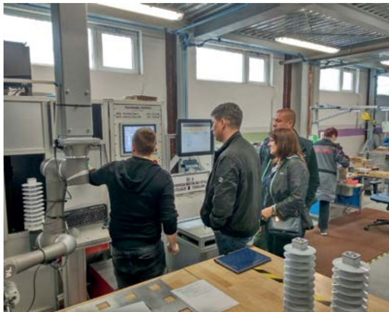
■ Комисија: Ђиљана Фундук, Душан Несторов и Милан Обрадовић на пријемном испитивању одводника пренапона 35 kV код произвођача „Изоелектро“ из Словеније
