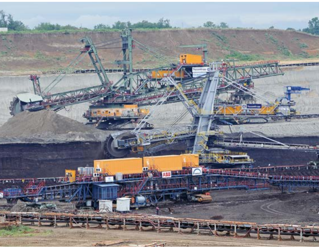
У току је годишња инвестициона оправка првог јаловинског система на „Тамнава – Западном пољу“
