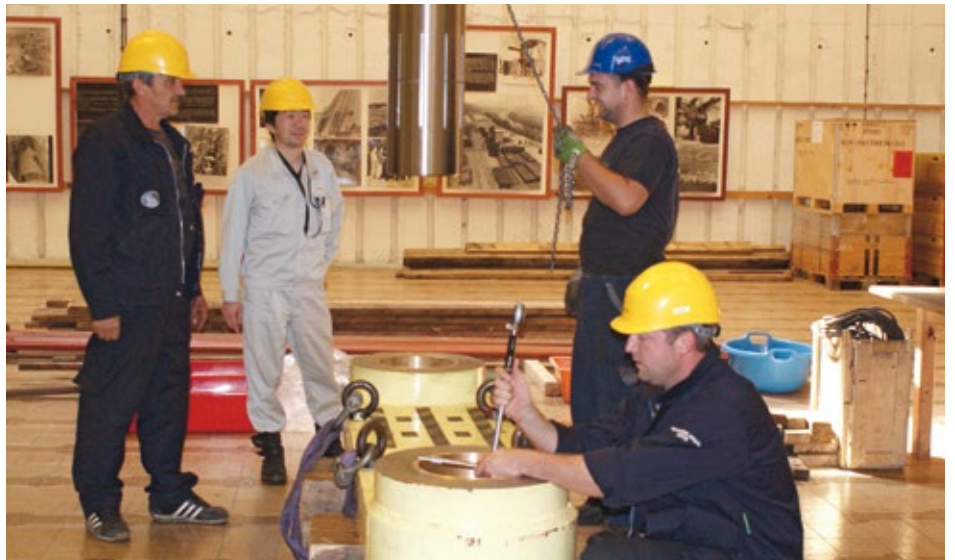
Заменом хабајућих делова на обе стране регулационог прстена отклоњен је досадашњи проблем који се манифестовао у повећаним вибрацијама и буци агрегата
