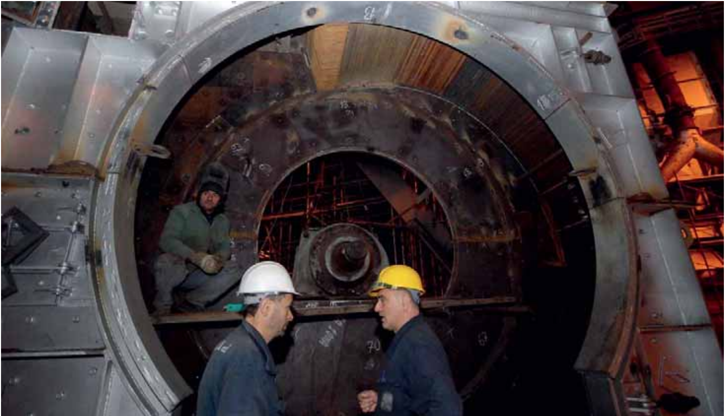
Угаљ се у млиновима меље на два начина: „чекићањем“ и „вентилаторски“
