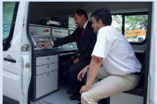
Мерна кола опремљена и најмодернијим уређајима за снимање грешака на подземним кабловима
